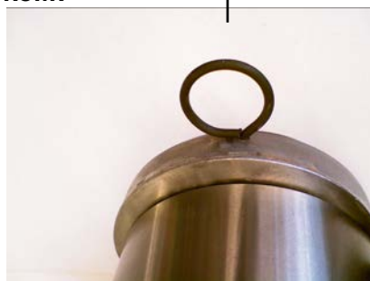
Obr. 3 varianta 2 – Po montáži řemenu vytáhněte kolík
